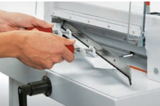
Remplacement de la lame Remplacement aisé de la lame par l'avant sans démonter les carters, grâce au dispositif protégeant le tranchant.
